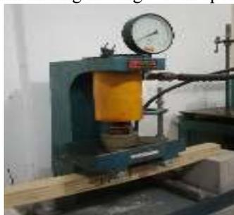
Gambar 4.3 Proses pengujian lentur
