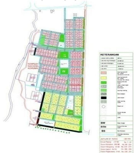
**Gambar 5. Peletakan Unit Hunian Berdasarkan Ukuran Lahan**
