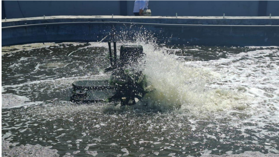
Gambar 1. Pengaplikasian Kincir Air pada Bak Pemeliharaan Udang vaname di BPIU2K Karangasem
